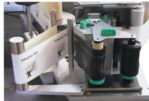
Système d'impression par transfert thermique intégré, géré par ordinateur.
